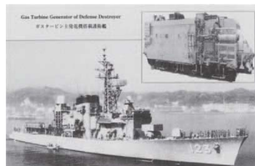
Fig. 2 M1A-02ガスタービン主発電機と搭載護衛艦
