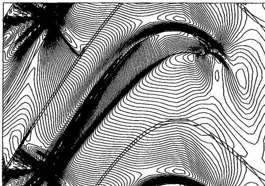
図 9 等マッハ線図及び速度ベクトル図 (翼端間隙中央面)
