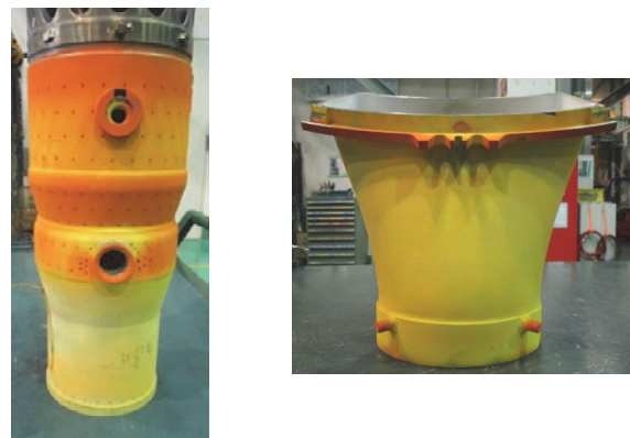
燃焼器チャンバ トランジションダクト Fig. 12 Thermal index paint of combustor parts
