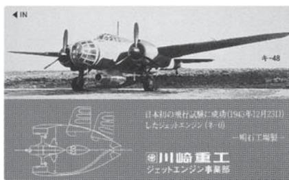
図2 ネ-0装着 キ-48 爆撃機初飛行成功
