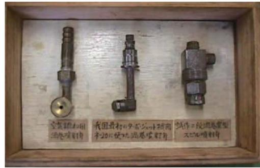
図3 「ネ-20」に使われた燃料噴射弁
