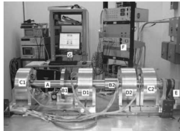
Fig. 4 A photograph of the flexible rotor AMB test rig: (A) Flexible rotor, (B1 and B2) Gyroscopic discs, (C1) Radial support AMB at the non-driven end, (C2) Radial support AMB at the driven end, (D1) Exciter AMB at mid-span location, (D2) Exciter AMB at quarter-span location, (E) VFD motor drive, (F) Signal conditioning and amplifiers rack, and (G) DSP and Control PC
