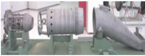
Fig. 4 乾式予混合型低NO x 燃焼器
