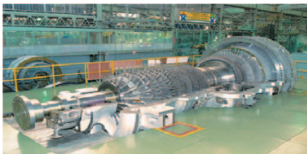
Fig. 2 製作工場でのMW-701Dガスタービン
