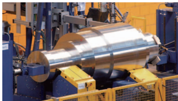
Fig. 7 A-USC用Ni基試作ロータ
