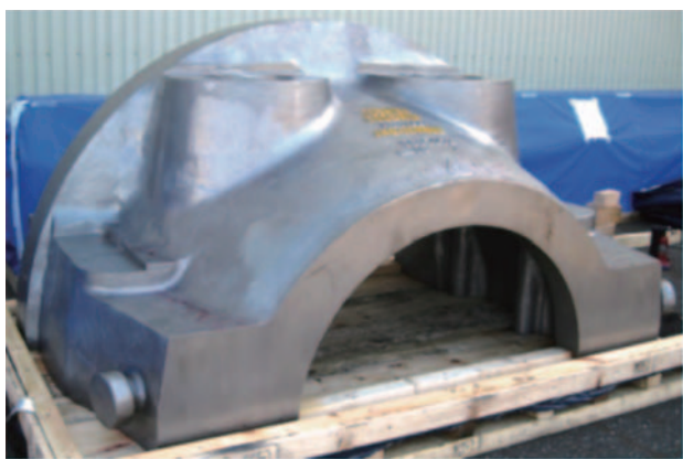
Fig. 9 Ni基鋳鋼ケーシング試作品
