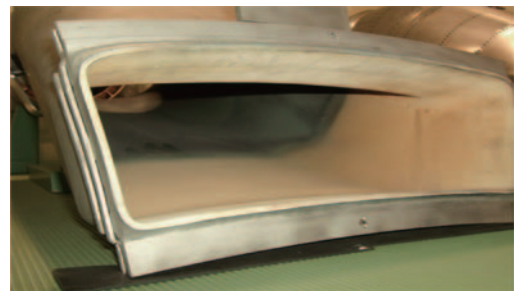
Fig. 6 出口部全面にTBC施工した燃焼器尾筒
