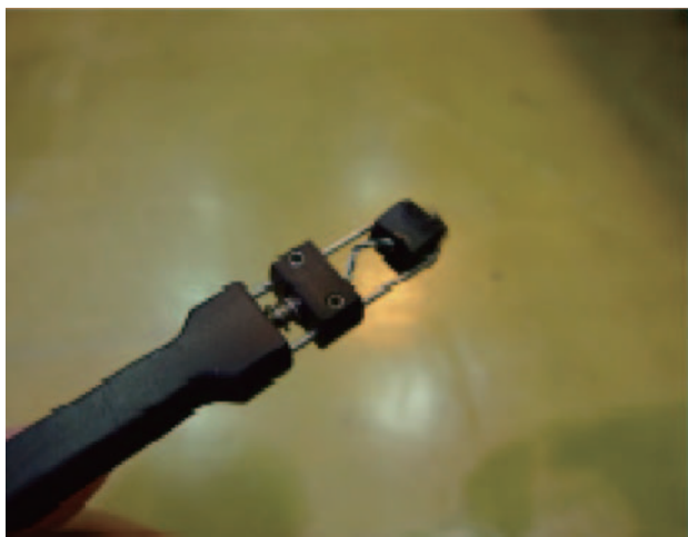
Fig.9 電磁誘導検査のセンサー部
