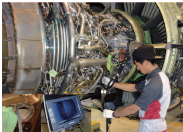
Fig.4 ボアスコープケーブルの挿入状況
