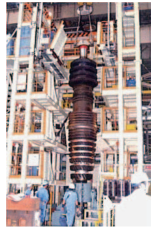
図2 ロータ精密点検
